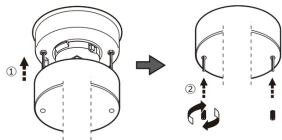
②ボルトに固定ネジを時計回りにまわして取り付けをしっかりと固定してください。(2か所)
