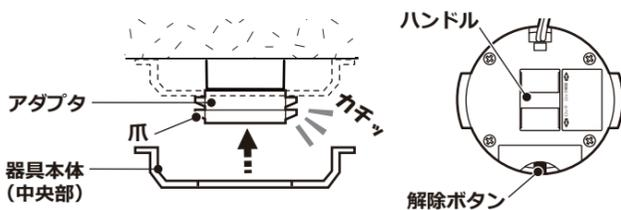
注意 配線器具の高さに応じて緑の爪部で調節します。
