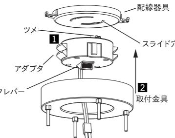
確認 配線器具の厚みによって取付金具の取り付け位置が異なります。下図をご確認ください。
