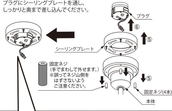
天井配線器具によって取り付け完了時のプラグの位置が違います。
