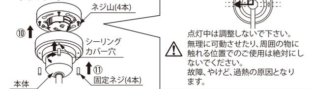
この時にネジ山をシーリングカバー穴に通す位置で角度を調整します。
