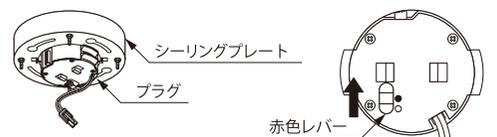
**警告 WAR.** プラグの引っ掛け刃が回転防止ツメに接触している場合は赤色のレバーが動きません。必ずプラグの引っ掛け刃が完全に出た状態で赤色レバーを「●レバーロック」に合わせてください。
