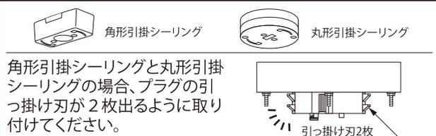
⊘ この時、回転防止ツメにプラグの引っ掛け刃が接触しない様にしてください。落下の原因になります。
