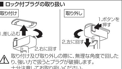
取り付け及び取り外しの際に、無理な角度で回したり、強い力で扱うとプラグが破損します。
