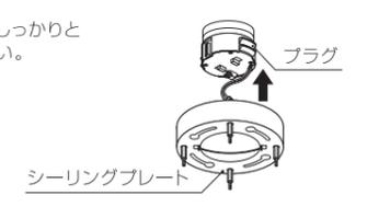
**⚠** 天井配線器具によって取り付け完了時のシーリングプレートの位置が違います。
