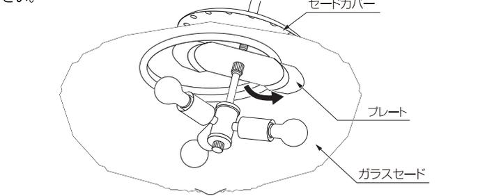
④セードカバーを下ろし、図のようにプレートとはさむようにセード固定ネジで固定してください。
