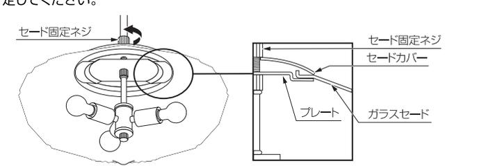
ネジを固定する前に、プレートにガラスセードが乗っているか、ガラスセードがプレートと平行になっているか確認してください。ネジを固定した後は再度、ガラスセードがしっかりと固定されているか確認してください。
