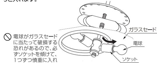
電球がガラスセードに当たって破損する恐れがあるので、必ずソケットを傾けて、1つずつ慎重に入れてください。
